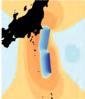
図 6 房総沖の想定巨大地震に伴う津波の線形長波理論適用時のスナップショット。青色は隆起,赤色は沈降を示す。(a)津波発生時(0分)のスナップショット。(b)10分後のスナップショット。(c)20分後のスナップショット。(d)30分後のスナップショット。(e)40分後のスナップショット。(f)50分後のスナップショット。(g)60分後のスナップショット。(h)70分後のスナップショット。(i)80分後のスナップショット。(j)90分後のスナップショット。(k)100分後のスナップショット。(l)110分後のスナップショット。(m)120分後のスナップショット。
