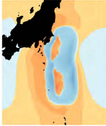
図 6 房総沖の想定巨大地震に伴う津波の線形長波理論適用時のスナップショット。青色は隆起,赤色は沈降を示す。(a)津波発生時(0分)のスナップショット。(b)10分後のスナップショット。(c)20分後のスナップショット。(d)30分後のスナップショット。(e)40分後のスナップショット。(f)50分後のスナップショット。(g)60分後のスナップショット。(h)70分後のスナップショット。(i)80分後のスナップショット。(j)90分後のスナップショット。(k)100分後のスナップショット。(l)110分後のスナップショット。(m)120分後のスナップショット。
